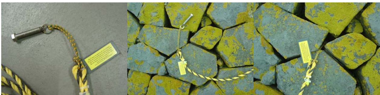
Zelfgemaakt steenanker voor tussen basaltblokken en stenen
